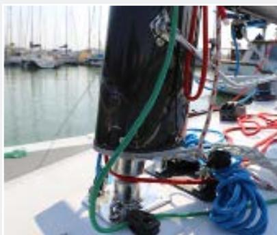
▲ Le mât aile en carbone de 11 m augmente la surface de la grand-voile.
