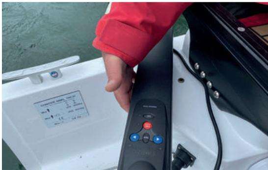
▲ Un second ergot, plus à l'extérieur, permet de stocker le pilote à plat, un peu plus loin de la barre. L'ergot visible sur cette image est celui qui maintient le pilote quand ce dernier est sollicité.
