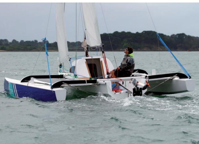
Les bras de liaison sont articulés et pivotent vers l'arrière. Pour le transport ou au port, les flotteurs se plaquent sur la coque centrale, limitant la largeur à 2,40 m.
