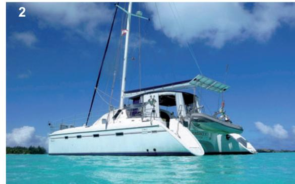
Privilège 435 n'est pas très vélocé par petit temps. En revanche, dès 3 Beaufort, il s'anime franchement. Les polaires de vitesse de l'architecte ne prédisent pas de miracle au près – en tout cas pour les modèles équipés d'ailerons : 6,5 nœuds par 15 nœuds de vent et 7,5 avec 5 nœuds de vent en plus. Mais au travers, par force 5, le 435/445 caracole à 12 nœuds.
