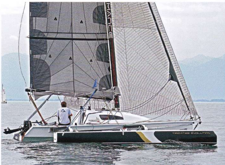
Der Code zero reicht bis ins Topp und beschleunigt das Boot in etwa auf Windgeschwindigkeit, wenn nicht die maximale Höhe am Wind gefordert ist.
