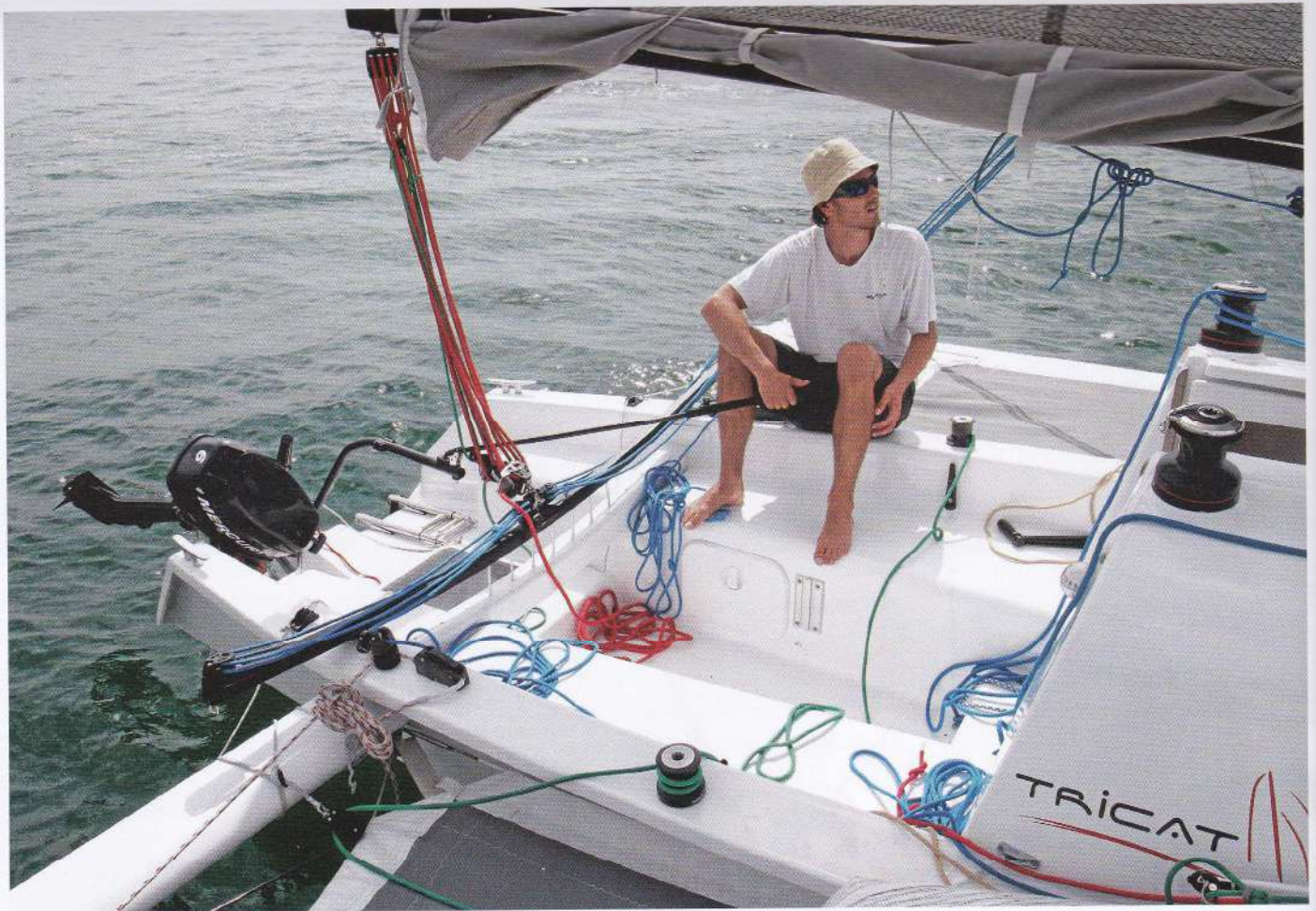
Der riesige Traveller ist nicht serienmäßig. Die Standardschiene wird auf dem Reitbalken montiert und endet am Deck. Dadurch wird das Platzangebot im Cockpit des Serienboots etwas großzügiger. Die Crew hält sich ohnehin eher auf dem Trampolin auf. Bei Leichtwind auf der Leeseite und bei stärkerem Wind auf dem Luvschwimmer. Die Decksausrüstung ist einfach gehalten und praxisgerecht.
