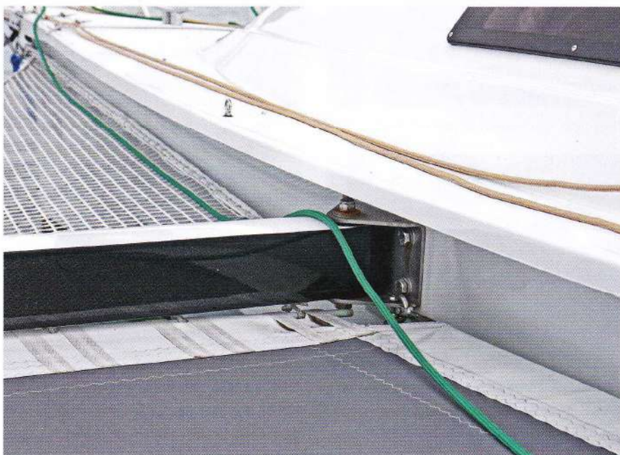
Mechanisch einfaches Gelenk am Rumpf. Drahtseile fixieren die Ausleger an ihrer Position und spannen diese zum Mittelrumpf.
