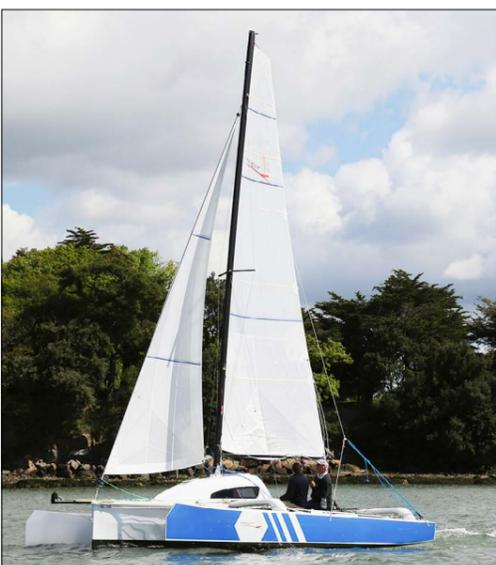
▲ Gréement carbone et GV à corne pour notre Tricat 20 configuré pour la vitesse.
