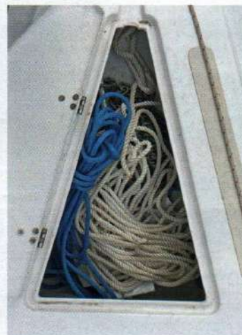
Der Ankerkasten nimmt auch die Festmacher auf. Er liegt zurückversetzt im vorderen Kajütaufbau
