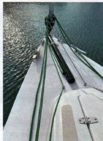
Der Bugspriet ist ausfahrbar und wird in einer Decksmulde geführt. So bleibt der Innenraum trocken
