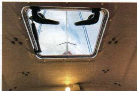
Unter Deck gibt es keine Innenschalen, keine Holzverkleidungen. Das Laminat ist aus Gewichtsgründen nur mit Topcoat versiegelt
