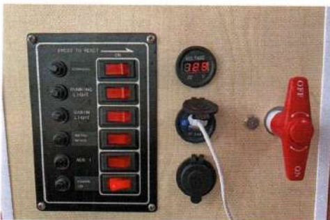
Für 1.950 Euro Aufpreis hat der Tricat eine 12-Volt-Versorgung, Licht, Ladebuchsen, Spannungsmesser und Positionslampen an Bord
