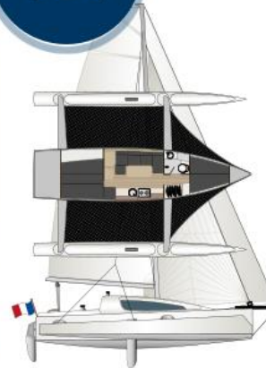
Statt eines Zentralschwerers hat der Tricat aufholbare Schwerter in den Schwimmern. Er baut sehr breit, auch zusammengeklappt
