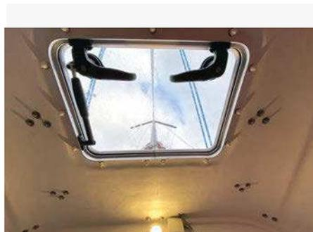
Sous le pont, il n'y a pas de coques intérieures, ni de boiseries. Pour des raisons de poids, le stratifié est uniquement recouvert d'une couche de finition de Topcoat
