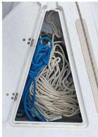
La baille à mouillage accueille également les amarres. Il est situé en retrait de la structure avant de la cabine.
