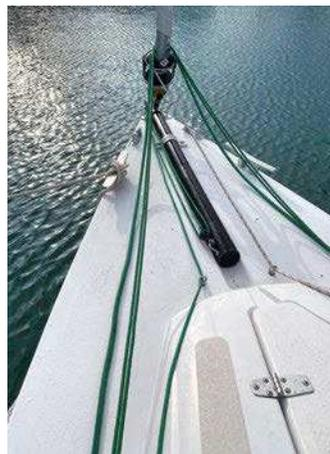
Le bout dehors peut être déployé et est guidé dans une moulure du pont. L'intérieur reste ainsi sec.
